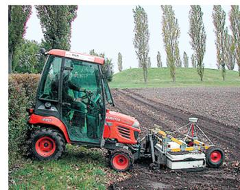
Ein motorisiertes Multikanal-Bodenradargerät im Einsatz. // LBI ArchPro
