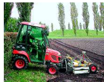
Ein motorisiertes Multikanal-Bodenradargerät im Einsatz. // LBI ArchPro
